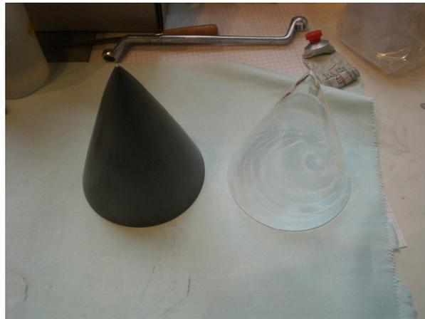
**Abbildung 3.2:** links: Konus mit Graphitbeschichtung, rechts: Konus ohne Beschichtung
