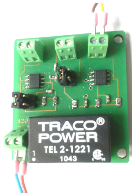
Abbildung 3.14 PCB Layout und gelötete Platine für den Fotodiodenverstärker
