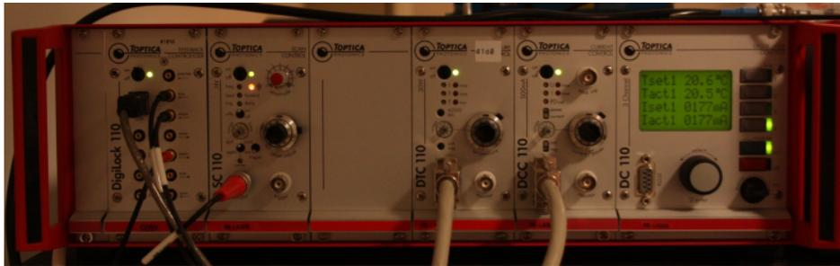
**Abbildung 3.9:** Die Abbildung zeigt die Elektronik zur Lasersteuerung und -stabilisierung.
