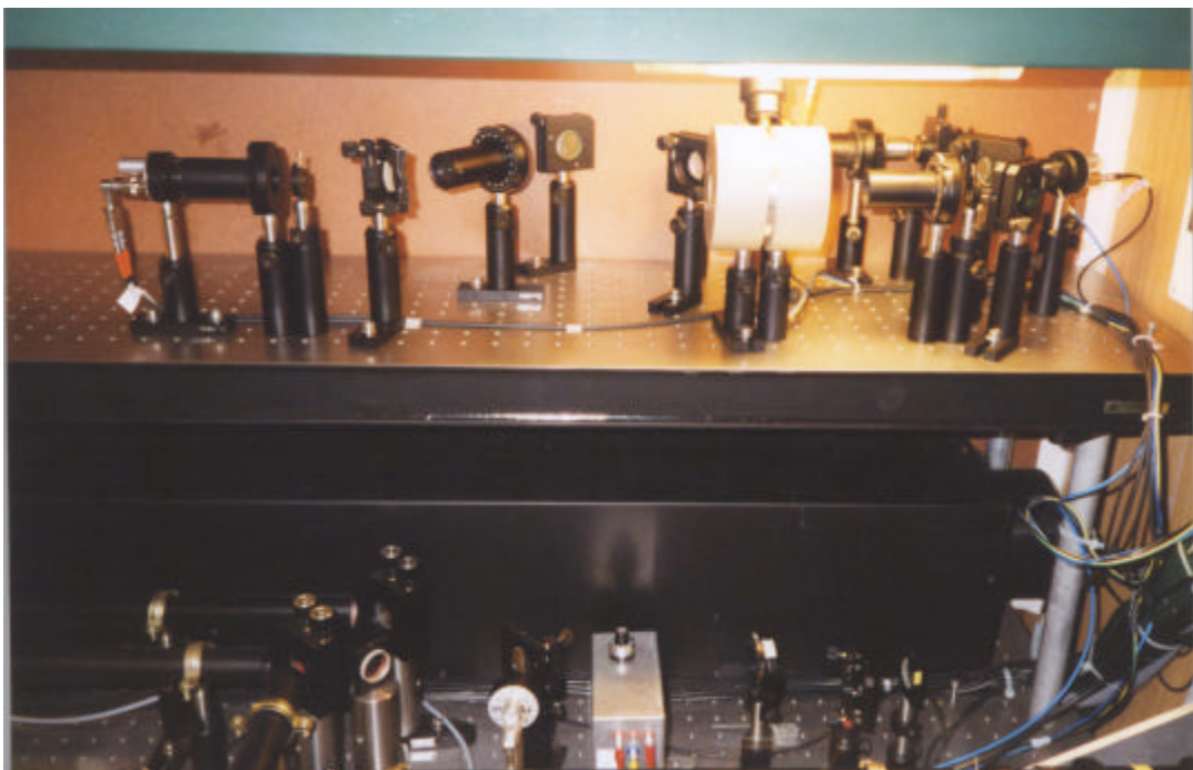
Abb. C8: dopplerfreie Polarisationspektroskopie im Meßcontainer
