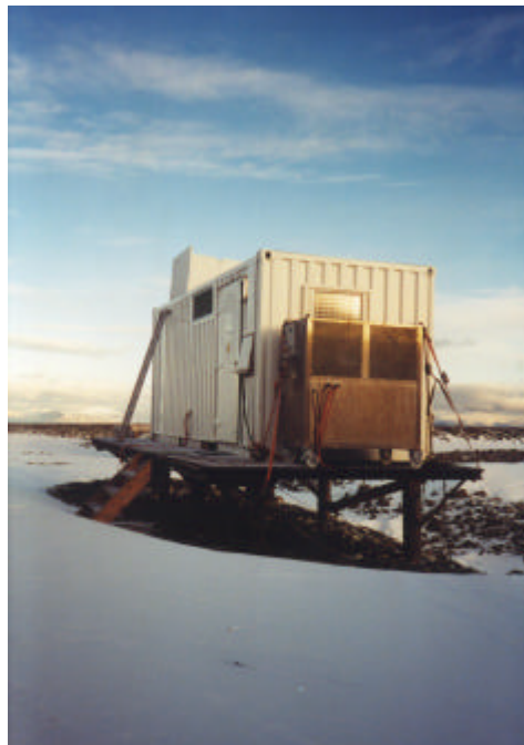
Abb. C6: Meßcontainer, Seitenansicht mit Kühlgerät für Alexandritlaser
