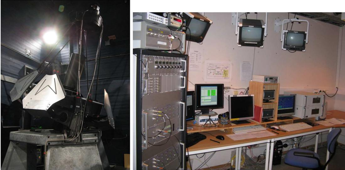
Abbildung 2.3.: Links: Eines der beiden Empfangsteleskope (Nord-West-Teleskop). Die Struktur ist ca. 4.5 m hoch. Rechts: Kontrollraum mit Datenerfassungselektronik sowie verschiedenen Steuerrechnern.
