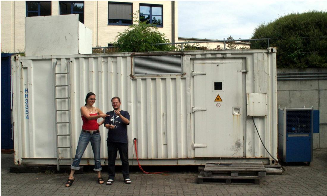
**Abbildung 2.4:** Das in einem 20 ft Container untergebrachte mobile Fe-Lidar steht momentan wegen Entwicklungsarbeiten am IAP in Kühlungsborn.
