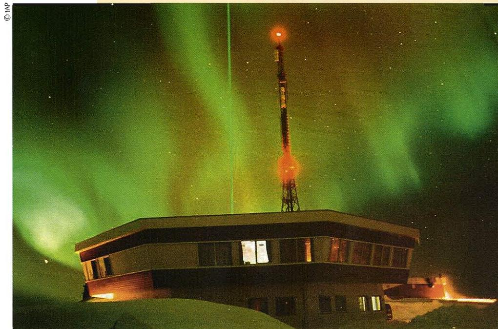
Der Laserstrahl des LIDARs (Light Detection And Ranging) weist über zurückgestreutes Licht nicht nur Teilchen in der Atmosphäre nach, sondern liefert auch Informationen zur Temperatur in großen Höhen.
