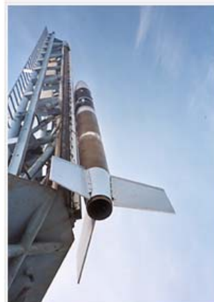
Die Forschungsrakete REXUS ist bereits auf der Startrampe montiert. Bild: DLR
