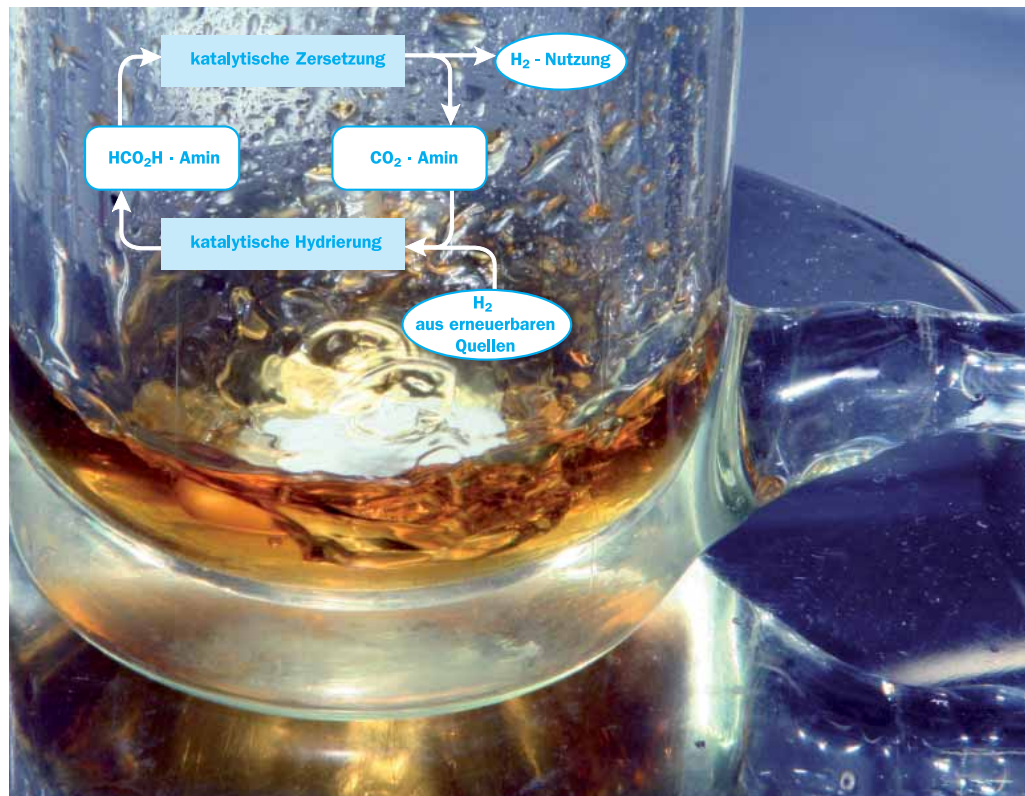
Die Zukunft beginnt im Glasreaktor; hier als Verbindung von Ameisensäure mit einem herkömmlichen Katalysator. Am LIKAT gelang es erstmals, auf diese Weise Wasserstoff bei Zimmertemperatur herzustellen. Foto: Schaeffner, LIKAT
