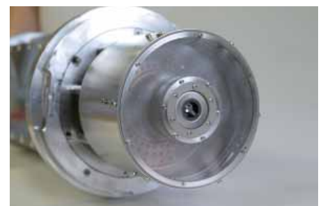
Meteorstaub-Detektor des IAP. In der Mitte deutlich zu sehen: die Xenon-Blitzlampe. Nach der Messkampagne fällt der Detektor an einem Fallschirm ins Meer und wird von dort geborgen. Foto: IAP
