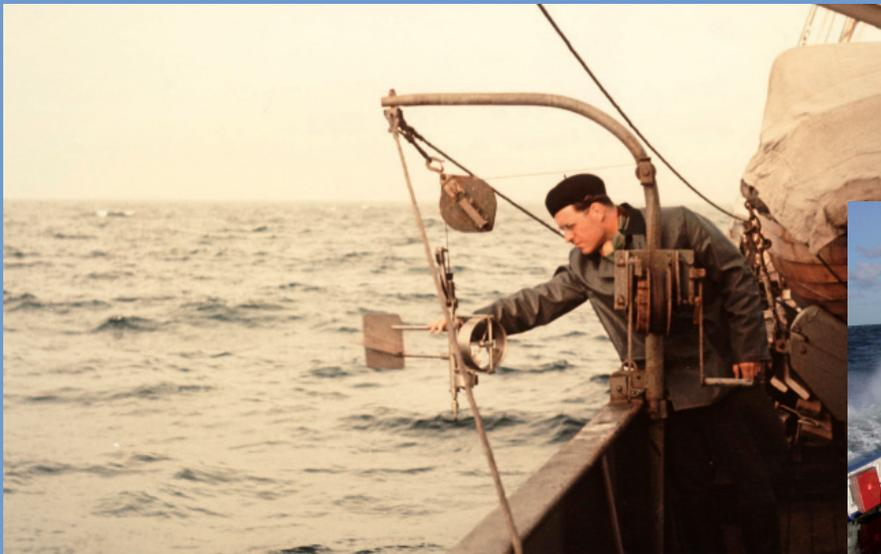
Links: Im Februar 1952 - an Bord des Forschungsschiffes „Joh. L. Krüger“, der späteren „Professor A. Penck“, wird ein Strömungsmesser zum Einsatz gebracht. Grafik: Salzgehalt im Gotlandbecken 1968 bis 2005. Fotos/Grafik: IOW
