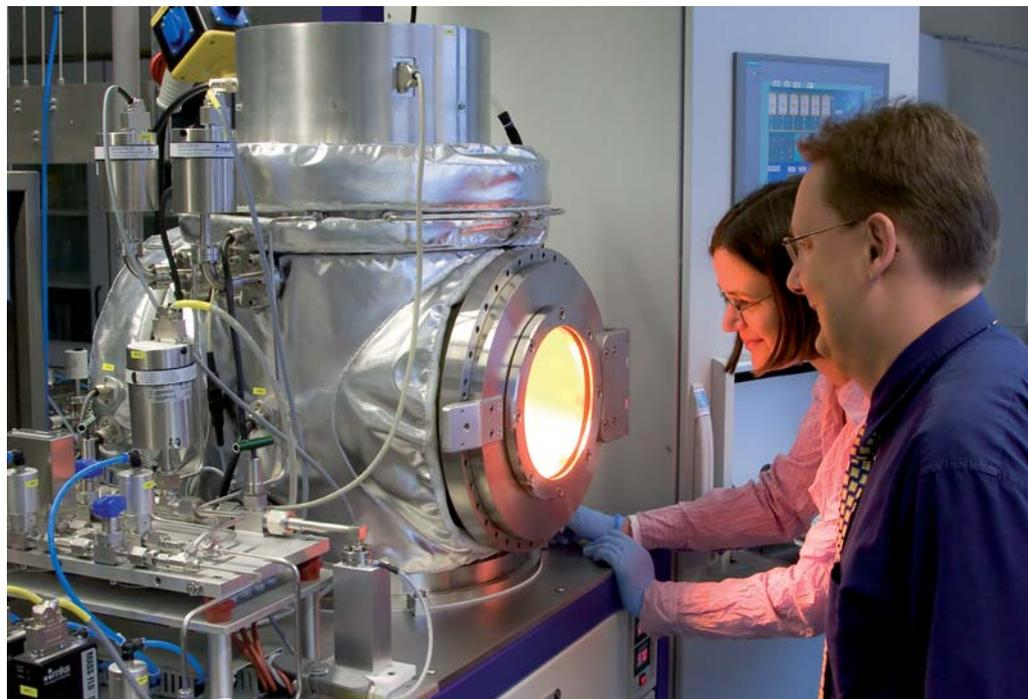
In diesem Plasmareaktor wird die Oberfläche von Kunststoffen für medizinische Anwendungen modifiziert. Karsten Schröder koordiniert das Projekt am INP, Antje Quade zählt zum Forscherteam. Foto: INP
