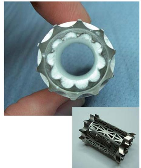
Formkörper mit eingebetteter Stützstruktur (oben), offene Titan-Stützstruktur (unten)
