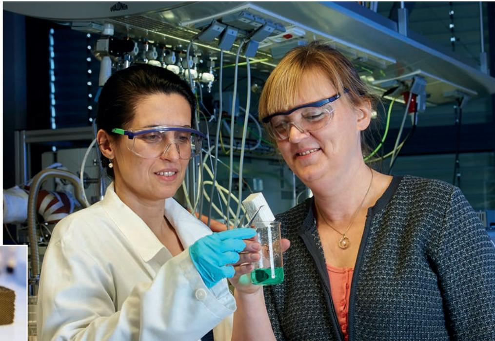
Heike Ehrich (rechts) und Elka Kraleva beim Beschichten des Monolithen mit dem Katalysator. Kleines Bild: Monolithe aus mineralischer Keramik, die als Matrix für den Katalysator dienen. Fotos: LIKAT
