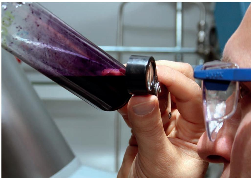
Marko Hapke begutachtet Einkristalle, die sich aus der Lösung eines Cobalt-Phosphin-Komplexes abscheiden. Diese Einkristalle sind von hoher Reinheit (daher kristallisiert man gerne zur Reinigung von Metallkomplexen) und erlauben die Strukturaufklärung durch die Röntgenstrukturanalyse.
