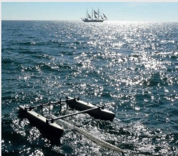
Leichtes Mikroplastikmaterial reichert sich an der Meeresoberfläche an. Mit einem Netz, das durch einen Katamaran an der Oberfläche gehalten wird, lässt es sich gut beproben.
