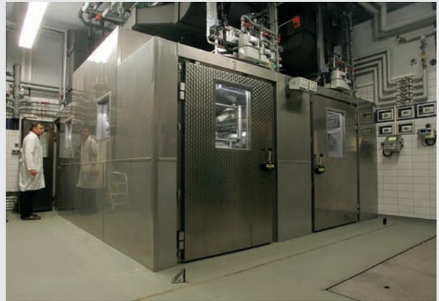
Abb. 2: Respirationkammer zur hochgenauen Bestimmung der Methanproduktion.
