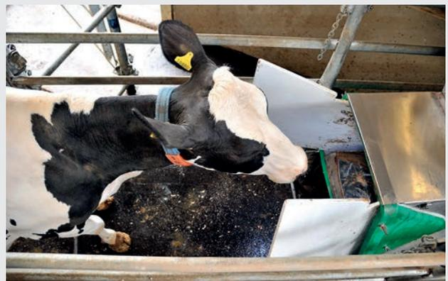
Abb. 3: Mobile Messstation zur Bestimmung der Methanproduktion im Stall oder auf der Weide
