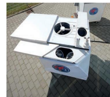
Das neue VAHCOLI-System mit fünf Sichtfeldern bereit für eine Messung. Im Hintergrund der Prototyp mit nur einem Sichtfeld. Foto: Franco-Diaz, IAP
