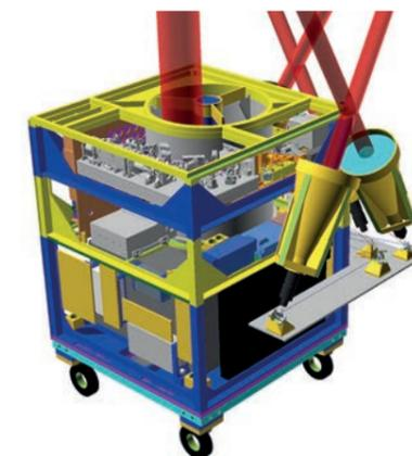
CAD-Zeichnung eines VAHCOLI-Systems mit fünf Sichtfeldern und eingezeichneten Laserstrahlen. Grafik: IAP
