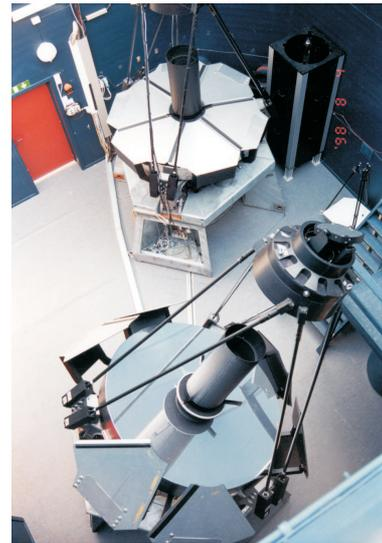
**Abb. 1.2** Die beiden Empfangsteleskope des ALOMAR RMR Lidars mit Spiegeln von 1,8 m Durchmesser.
