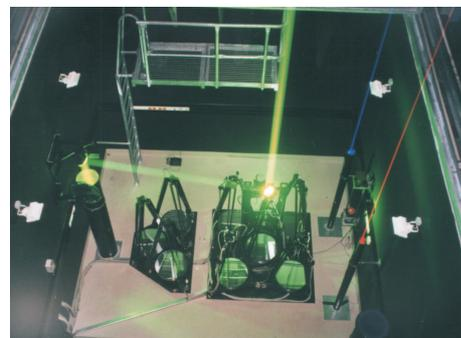
**Abb. 1.3** Links: Neubau des IAP, hier zu sehen mit dem „Lidar-Flügel“ (nach links in Richtung Wald). In der Mitte des Lidar-Flügels befindet sich die Halle mit den Teleskopen. Rechts: Die 8 Empfangsteleskope im Instituts-Neubau mit eingeschalteten Laserstrahlen: grün der des Rayleigh-Lidars, orange der des Natrium-Lidars und blau der des Calcium-Lidars.
