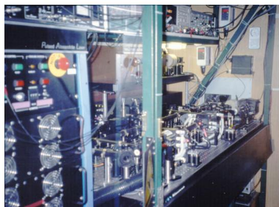
**Abb. 1.6** Ein Blick in den Container, vollgestopft mit der notwendigen Technik. Auf dem Tisch ist die gesamte Sendeeinheit mit dem Alexandrit-Laser aufgebaut.
