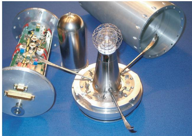
**Abb. 10.1** Der CONE-Sensor mit Elektronik, Vakuumhaube und Raketenzyylinder
