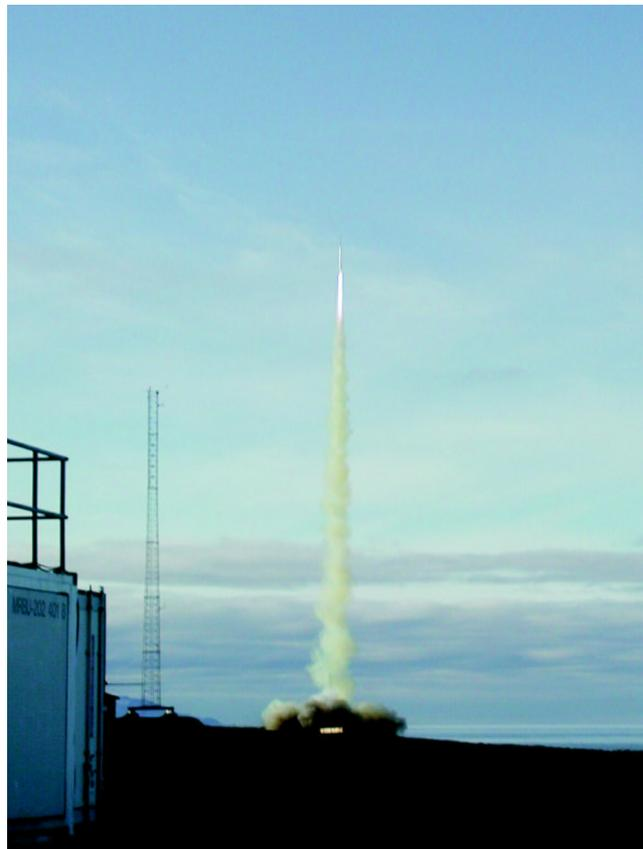
**Abb. 9.1** Start einer meteorologischen Rakete von Svalbard,  $78^{\circ}N$ . Die fallende Kugel wird in einer Höhe von etwa 90-100 km ausgestossen und erreicht ein Apogäum von etwa 115 km. Die Gesamtlänge der Rakete (Motor plus Nutzlast) beträgt 3,60 m.
