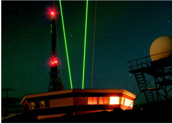
Abb. 1.3: Das ALOMAR-Observatorium auf der Insel Andøya in Nord-Norwegen mit den für Windmessungen 30^\circ aus dem Zenit gekippten Laserstrahlen des RMR-Zwillingslidars (grün, sowie infrarot und ultraviolett) sowie des ALOMAR-Na-Lidars (orange)
