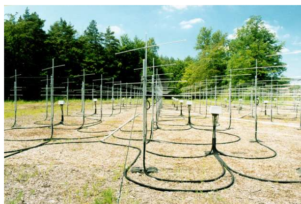
Abb. 22.3: Blick durch das OSWIN-Antennenfeld
