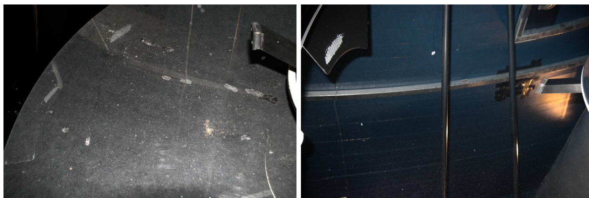
Abb. 2.5: Alter Primärspiegel (links) und neuer Primärspiegel (rechts) des ALOMAR RMR-Lidars. Die alten Primärspiegel wurden im September 2005 ausgetauscht, was zu einer deutlichen Verbesserung der Systemempfindlichkeit führte, insbesondere für die UV-Messungen.
