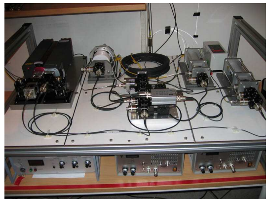
Abb. 5.6: Neue Seedlaser-Einheit des ALOMAR RMR-Lidars. Oben hinten von links nach rechts: Laser, Jodzelle, elektro-optische Modulatoren.
