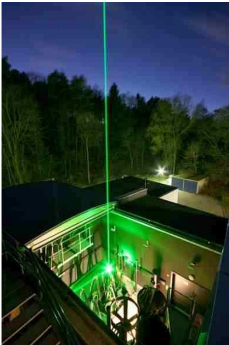
Abb. 4.2: Teleskophalle des IAP-Hauptgebäudes in Kühlungsborn mit dem Laserstrahl des RMR-Lidars (grün, sowie infrarot und ultraviolett).
