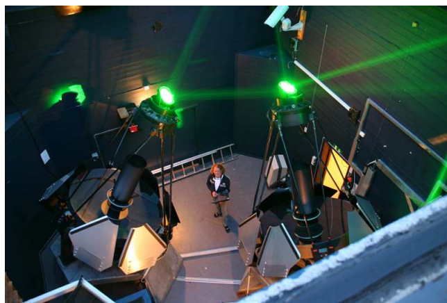
Abb. 4.3: Teleskope des ALOMAR RMR-Lidars in Nord-Norwegen mit Nd:YAG-Laserstrahlen (grün, sowie infrarot und ultraviolett). Die Teleskope sind für Windmessungen 30^{\circ} aus dem Zenit geneigt.
