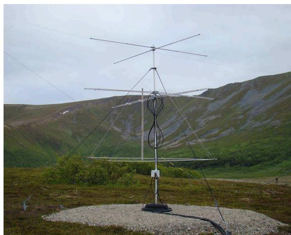
**Abb. 19.7:** Meteor-Radar-Sendeantenne
