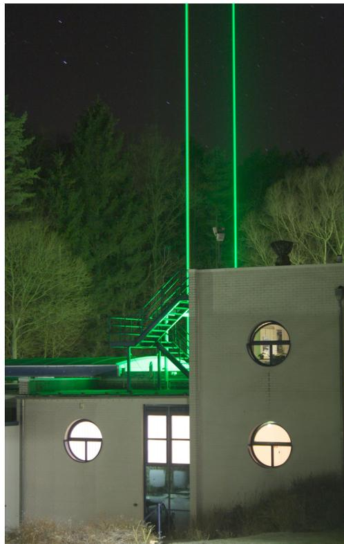
**Abb. 4.2:** Teleskophalle des IAP-Hauptgebäudes in Kühlungsborn mit den Laserstrahlen der RMR-Lidars (grün sowie infrarot und ultraviolett)
