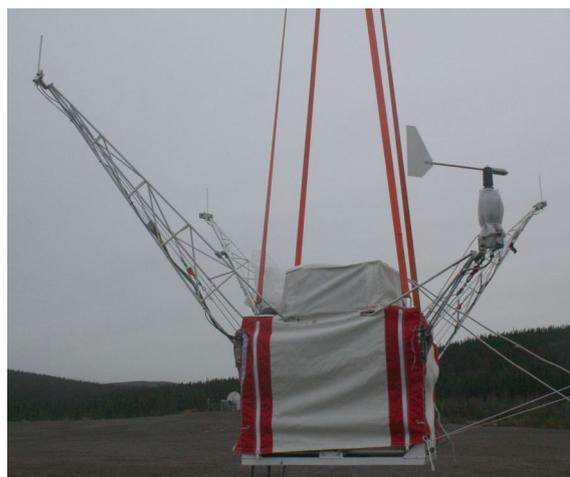
**Abb. 16.3:** Nutzlast von BEXUS 12 am 27. September 2011 in Kiruna mit den Auslegern für die Turbulenzsensoren für Wind und Temperatur. Die Windfahne dient zur Bestimmung der Ausrichtung der Gondel relativ zur Luftströmung.
