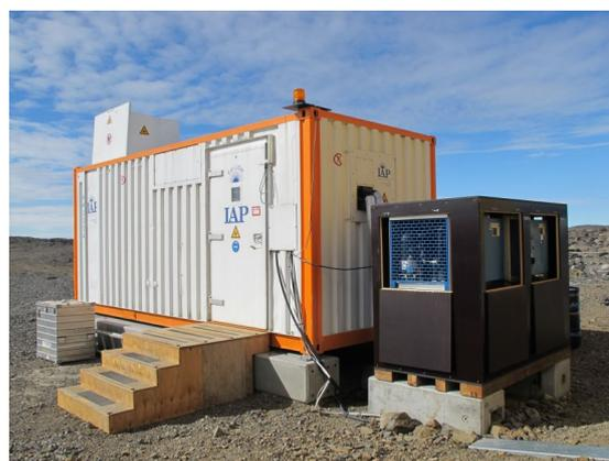
**Abb. 5.4:** Fe-Lidar in Davis nach dem Aufstellen im Sommer
