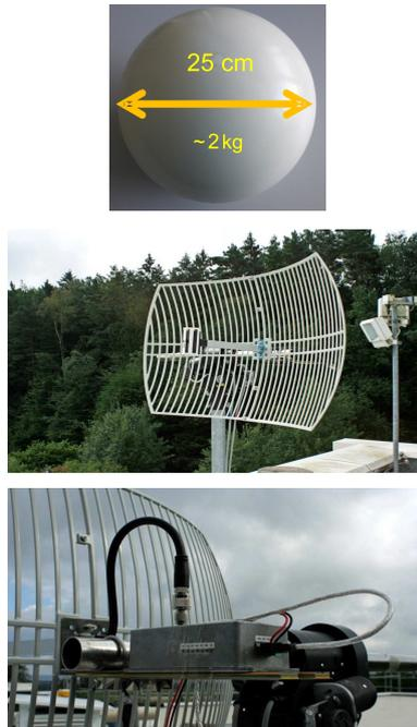
**Abb. 27.1:** Oberes Bild: Foto und Maße der neu entwickelten fallenden Kugel; mittleres Bild: Empfangsantenne mit bodengebundenem TM-Station; unteres Bild: bodengebundene TM-Station
