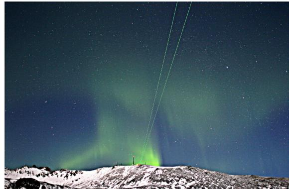
**Abb. 4.3:** ALOMAR RMR-Lidar in Nordnorwegen. Die Laserstrahlen sind für Windmessungen 20° aus dem Zenit geneigt.
