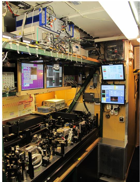
**Abb. 6.1:** Aufbau des geseedeten Alexandrit-Ringlasers mit Steuerung und Frequenzmessung, 2010
