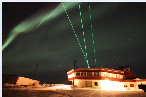
**Abb. 4.2:** ALOMAR RMR-Lidar in Nordnorwegen. Die Laserstrahlen sind für Windmessungen 20° aus dem Zenit geneigt.
