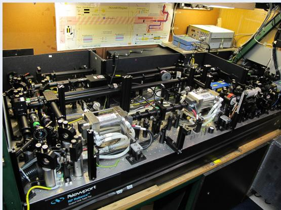
**Abb. 5.1:** Blitzlampengepumpter Alexandrit-Ringlaser des mobilen Fe-Lidars
