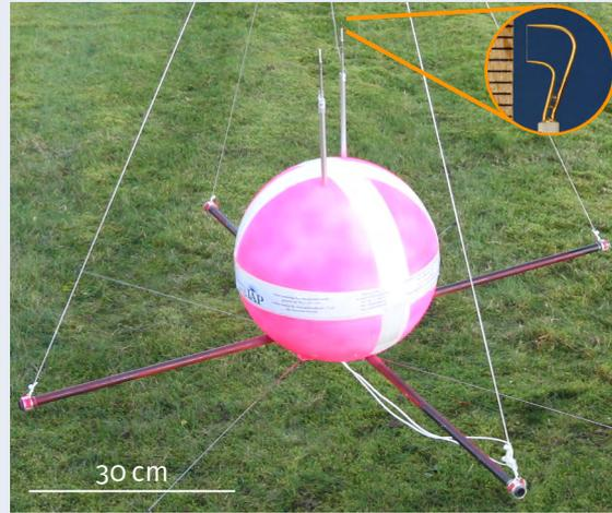
**Abb. 15.1:** Foto der neuen Ballonnutzlast. Im Ausschnitt in der oberen rechten Ecke ist eine Vergrößerung des Drahtsensors gezeigt, die Striche auf dem Lineal neben dem Sensor sind Millimeter.
