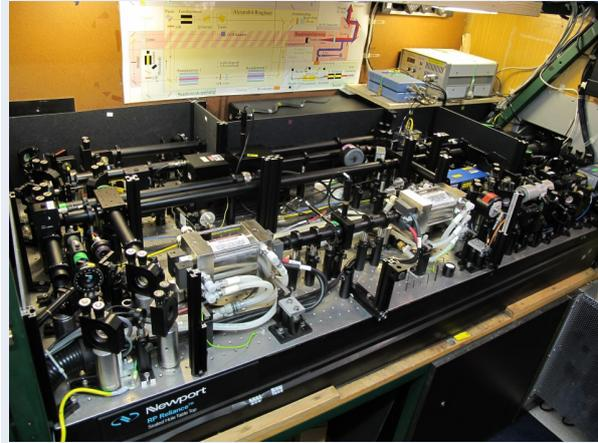
Abb. 18.1: Blitzlampengepumpter Alexandrit-Ringlaser des mobilen Fe-Lidars in Davis (69°S)
