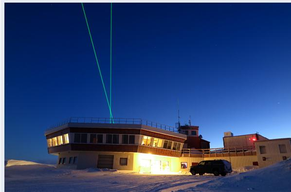
**Abb. 4.2:** Das ALOMAR RMR-Lidar in Nordnorwegen: Die Laserstrahlen sind für Windmessungen um 20° aus dem Zenit geneigt.
