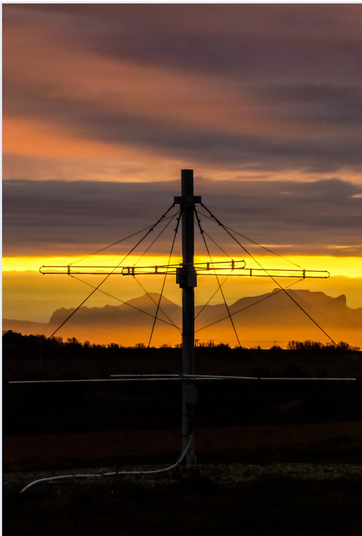
**Abb. 25.6:** Empfangsantenne des Andenes-Meteor-Radars auf der Insel Andøya
