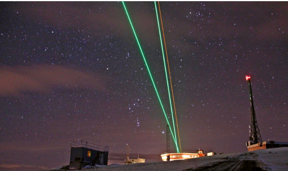
Grüne und orangene Strahlen am Himmel: Das ALOMAR-RMR-Lidar misst mit Hilfe von geschwenkten Laserstrahlen Wind und Temperatur in Nordnorwegen. Green and orange beams in the sky: The ALOMAR RMR lidar measures winds and temperature in northern Norway with tilted laser beams.
