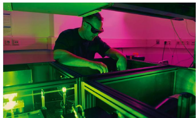
Justagearbeiten am Hochleistungslaser für die Wind- und Temperatursoundings in Kühlungsborn. Alignment work at the high-power laser used for the wind and temperature soundings at Kühlungsborn.
