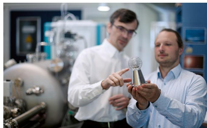
CONE-Sensor zur hochauflösten Messung von Neutralgas- und Elektronendichte und deren Schwankungen mit Höhenforschungsraketen.
